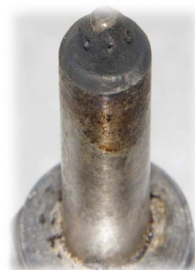
Zanieczyszczony wtryskiwacz paliwa
