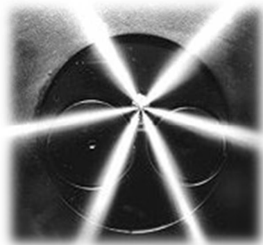
Czysty wtryskiwacz paliwa regularne ukształtowanie strugi paliwa przy zastosowaniu Energocet® 76
